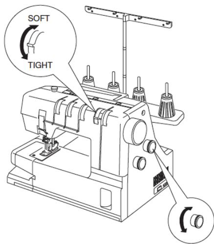
Sollte es während des Nähens Fehlstiche geben, bitte zuerst den Spannungs-Hebel auf TIGHT stellen, danach die Stichlänge auf 3 oder höher einstellen. Sollte der Stoff während des Nähens sich etwas kräuseln, bitte den Spannungs-Hebel auf SOFT stellen (die Scheiben der Untergreifersonnen öffnen sich). Auch hier gilt, wenn nötig die Stichlänge etwas höher stellen.
