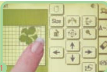
**1** Öffnen Sie ein Muster. Verschieben Sie es mit der Fingerspitze im Stickbereich. Fügen Sie Schriften oder weitere Motive hinzu. Ändern Sie nach Lust und Laune. Bestätigen Sie mit OK.
